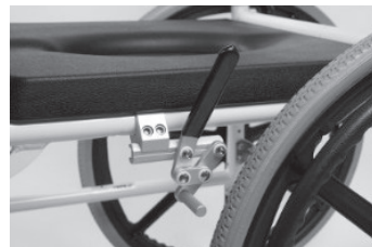
Joonis 4. Piduri paigaldamine raamile
